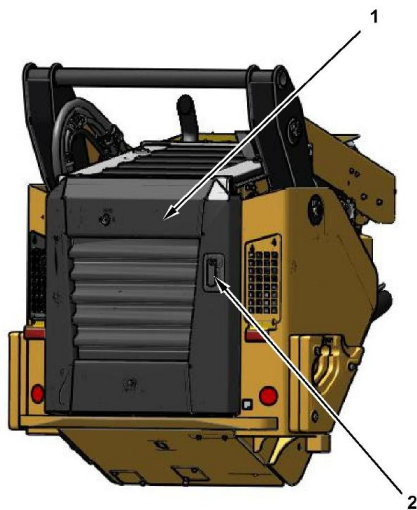
Рисунок 1 g06408722 (1) Технологический люк двигателя (2) Доступ с помощью рычажного фиксатора
